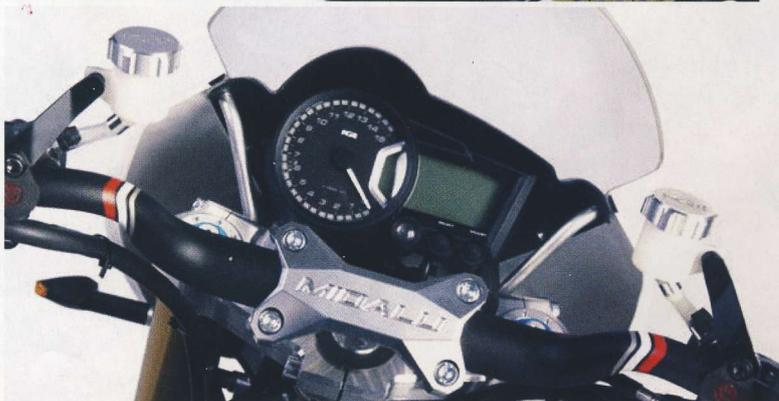
Apesar da elevada capacidade do motor, a Midalu consegue ser estreita na zona central, revelando um bom estudo ergonómico. Uma das peças que mais impressiona à vista é o braço oscilante realizado em alumínio, a partir de um bloco maquinado. Instrumentação digital e analógica, escondida atrás de um pequeno ecrã transparente que terá que anular parte da deslocação de ar proporcionada pelo poderoso conjunto
